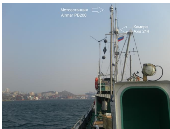
Рис. 2. Основные измерительные элементы программно-аппаратного судового комплекса наблюдения: метеостанция Airmar PB200 и PTZ-видеокамера Axis-214
