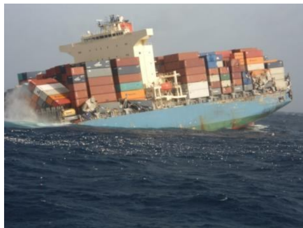
Рис. 2 Кормовая часть MOL Comfort тонет после разрушения корпуса (фото arachio)
