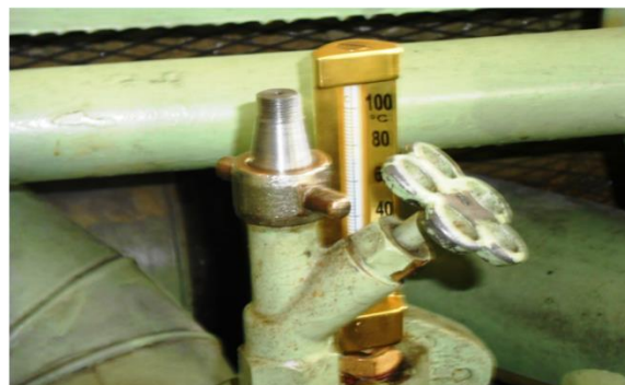
Рис. 3. Общий вид устройства для отбора частиц сажи из камеры сгорания судового дизеля 6ЧН 24/36
