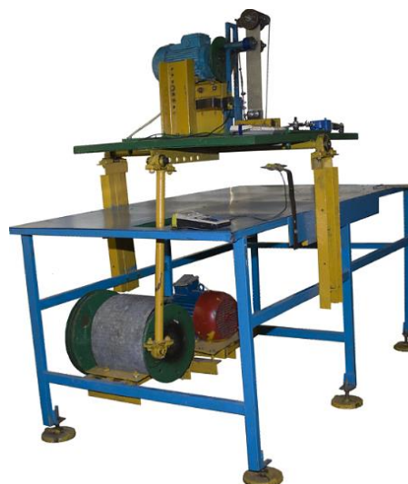
Рис. 2. Экспериментальная установка для проведения испытаний узлов соединений надстройки с корпусом на циклическую долговечность
