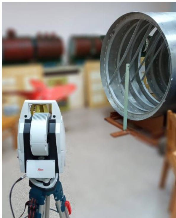
Рис. 3. Измерение цилиндрической конструкции с помощью лазерного трекера
