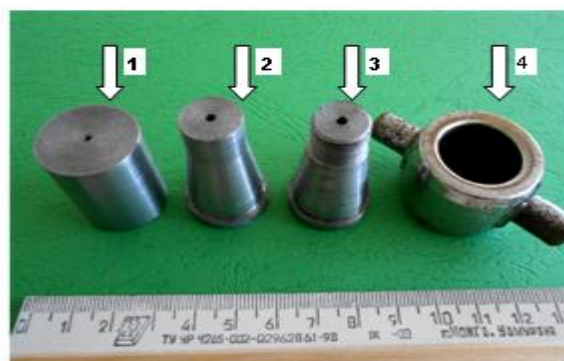
Рис. 4. Детали устройства для отбора проб частиц сажи из камеры сгорания судового дизеля 6ЧН 24/36: 1 – цилиндрическая насадка с отверстием диаметром 1 мм; 2 и 3 – сопла (основное и запасное) с входным диаметром 8 мм и выходным диаметром 1,7 мм; 4 – накидная гайка для крепления устройства на индикаторный канал дизеля
