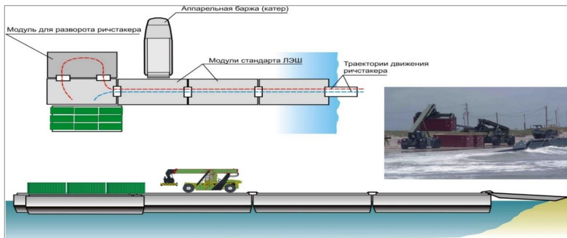
Рис. 10 – Основные элементы и компоновка лихтерной транспортно-технологической системы для работы на необорудованном побережье
