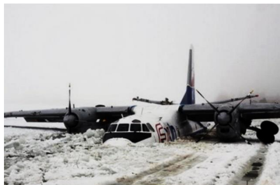
Рис. 2. Неудачная посадка самолетов на ледяной покров: а - разрушение льда под хвостовой частью самолета; б - разрушение льда под его фюзеляжем
