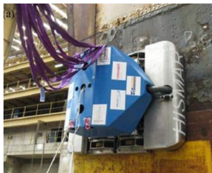
Рис. 1. Очистка корпуса судна с использованием мобильного устройства типа Hismar [21].
