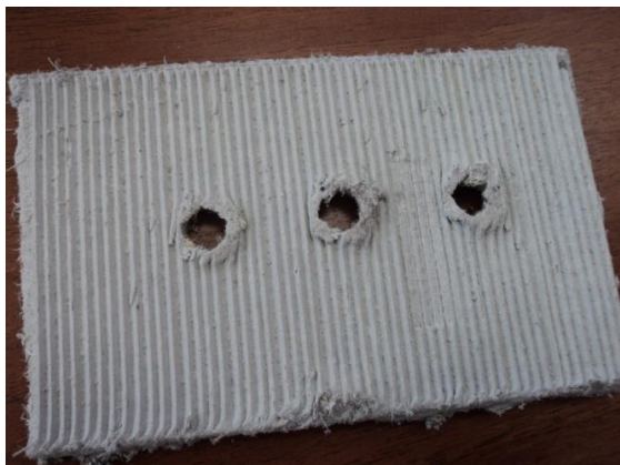
Рис. 4. Вид просверленных отверстий сверлом Ø12,5 в картоне КАОН-1 с рифленной стороны
