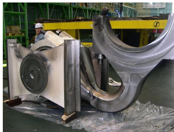
Рис. 2 – Фото изгиба стержня шатуна
