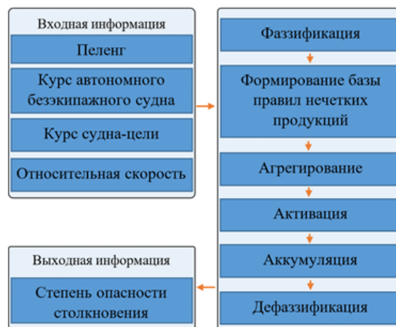
Рис. 4. Интеллектуальная оценка степени опасности столкновения морского судна по четырём переменным
