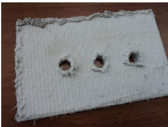
Рис. 5. Вид просверленных отверстий сверлом в картоне КАОН-1 после обжаривания
