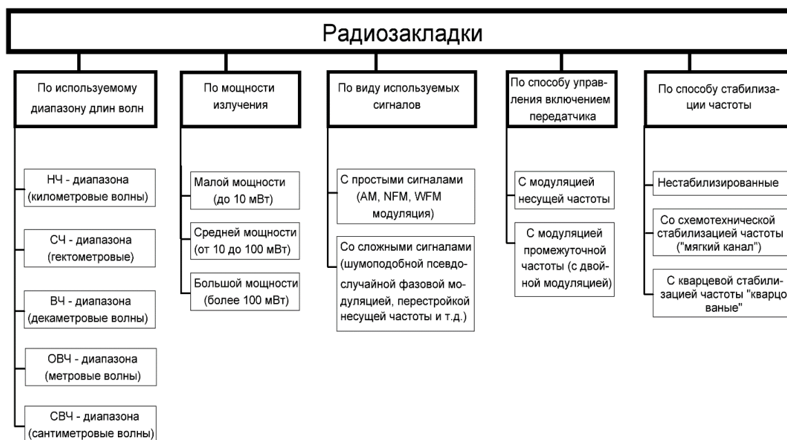
Рис. 2. Классификация закладных устройств, передающих информацию по радиоканалу
