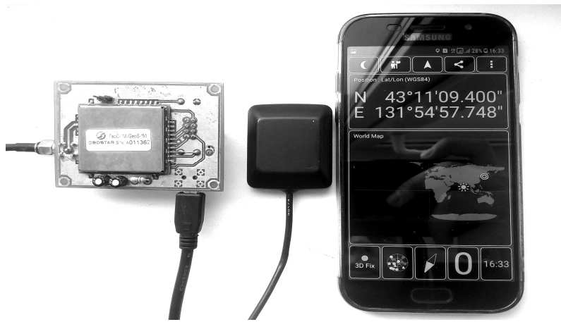
Рис. 4. Расположение двух приемников ГеоС-1М и Samsung galaxy A5 во время замера
