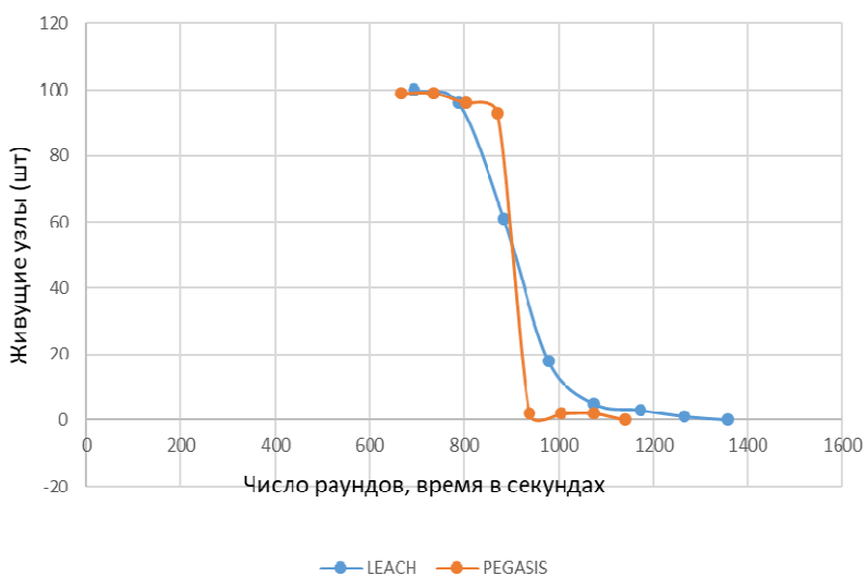
Рис. 5. Сравнительный график жизненного цикла сетей (зависимость числа живущих узлов от числа раундов)
