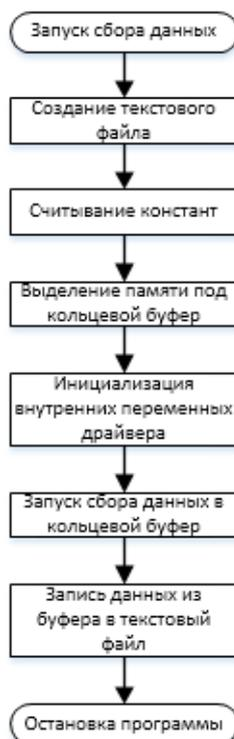
Рис. 3. Процесс сбора данных программой
