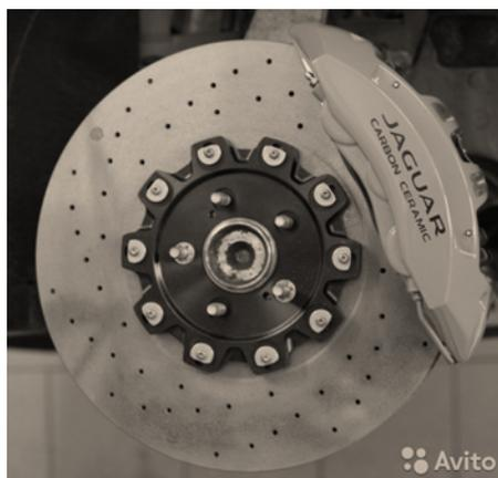
Рис. 2. Керамический тормозной диск
