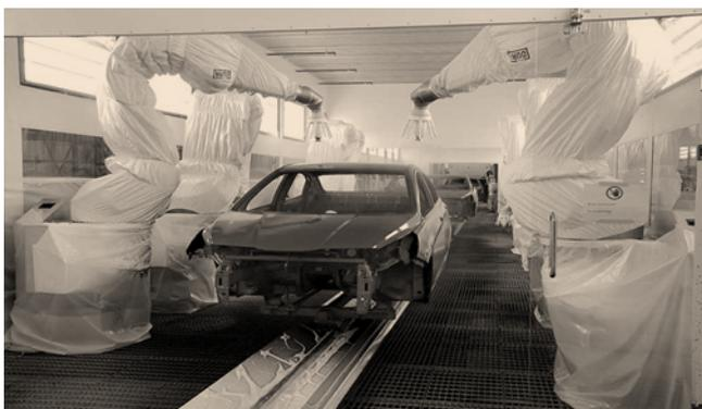
Рис. 3. Робот для покрасочных работ
