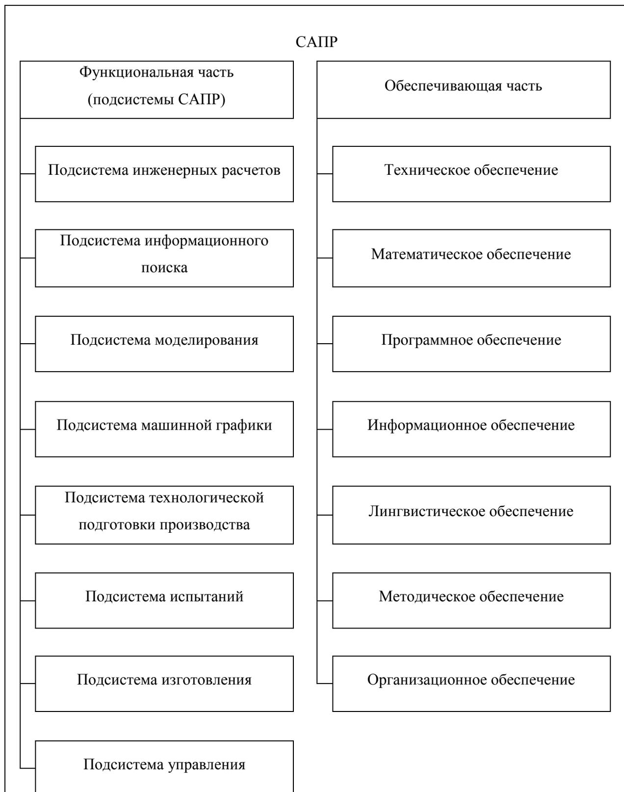
Рисунок 1 - Структурная схема САПР
