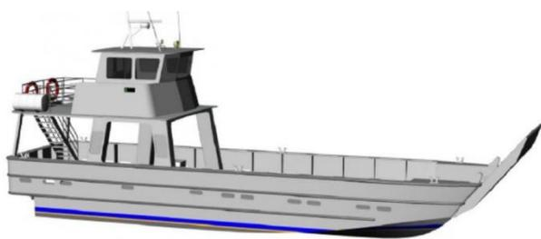
Рис. 12. Судно для доставки пассажиров и накатной техники на необорудованный берег ([www.boatsonline.com.au](http://www.boatsonline.com.au))
