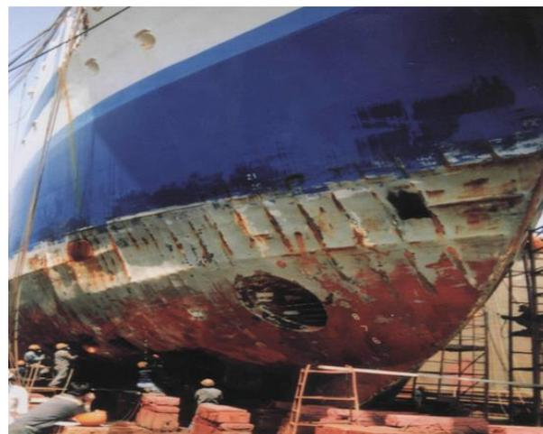
Рис.2. Пример тяжёлых ледовых повреждений судна при самостоятельном плавании
