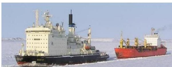
Рис.1. Пример индивидуальной проводки полярного судна ледоколом
