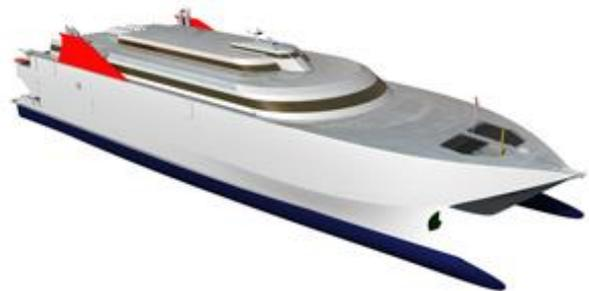
Рис. 11. Быстроходный грузопассажирский паром катамаранного типа с малой площадью ватерлинии компании Incat, Тасмания
