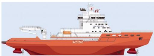
Рис. 6. Проект многофункционального ледокола Aker ARC 130A (<https://akerarctic.fi/>)
