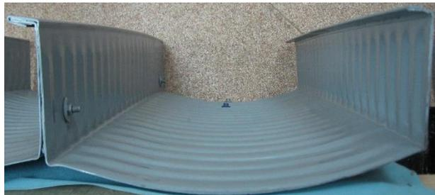
Рис. 2. Гнутолистовой тонкостенный гофрированный профиль с кривизной
