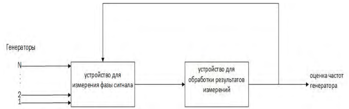
Рис. 1. Структурная схема системы стабилизации частоты N одновременно и независимо формирующих гармонические сигналы генераторов
