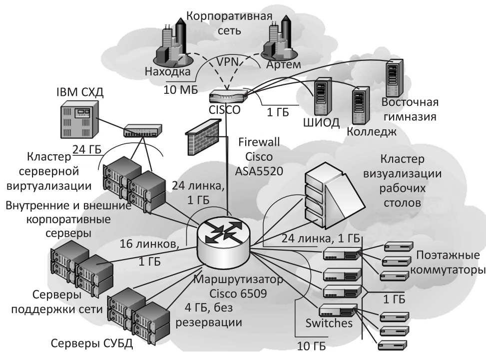
Рис. 1 Архитектура ЦОД ВГУЭС
