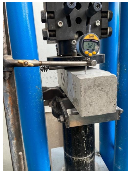
Рисунок 1. Схема испытания балки на изгиб 1 – Нагрузочный элемент; 2 – образец-балка; 3 – опора.
