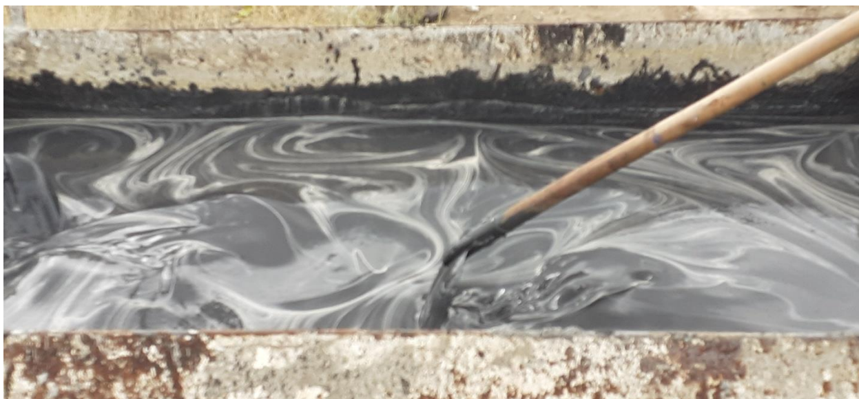
Рисунок 3 - Изменение фазового состояния битумной суспензии от полусухого до тиксотропного (жидкая фаза) после добавления в нее воды
