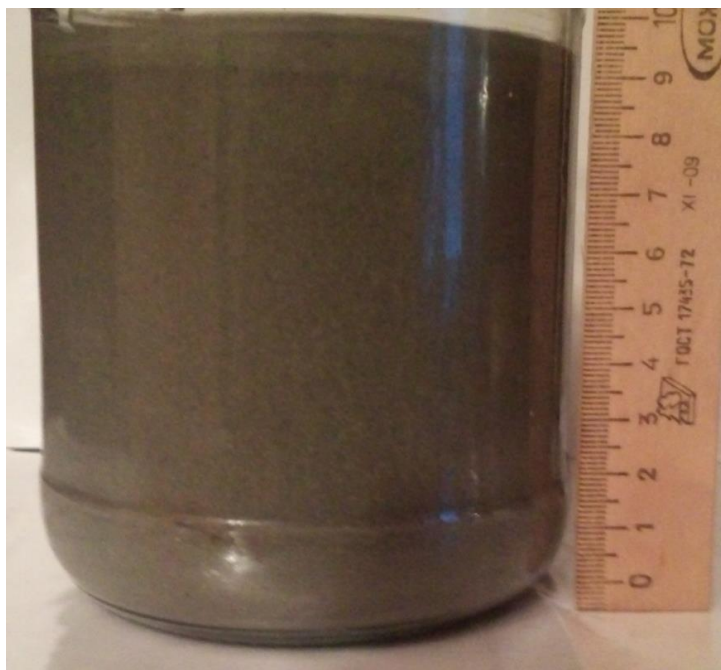
Рисунок 4 - Однородная смесь, полученная путем перемешивания взвеси фибры с 0,6 л битумной суспензии
