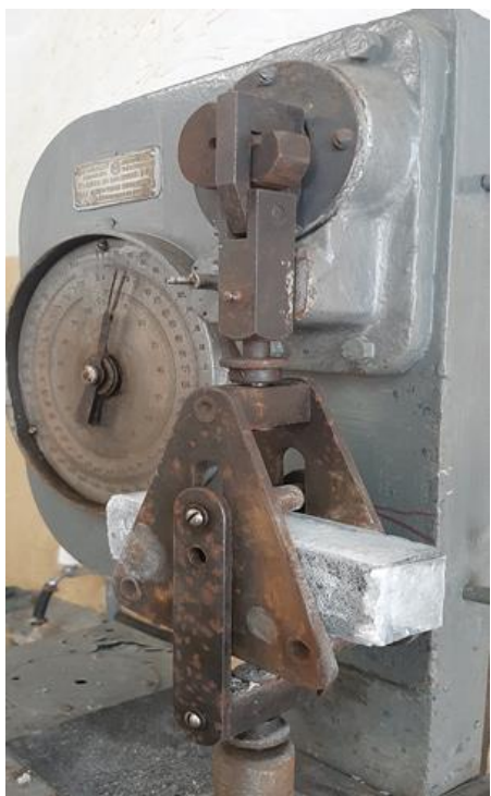
Рисунок 3 – Испытания образца на изгиб при растяжении
