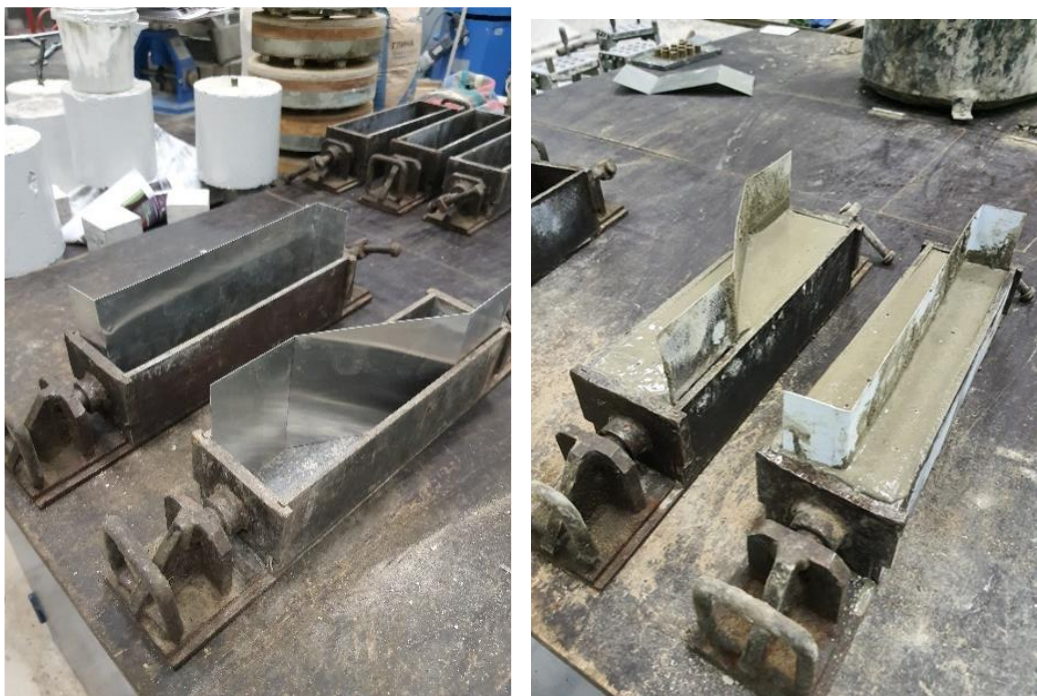
Рисунок 3 – Формование составных образцов
