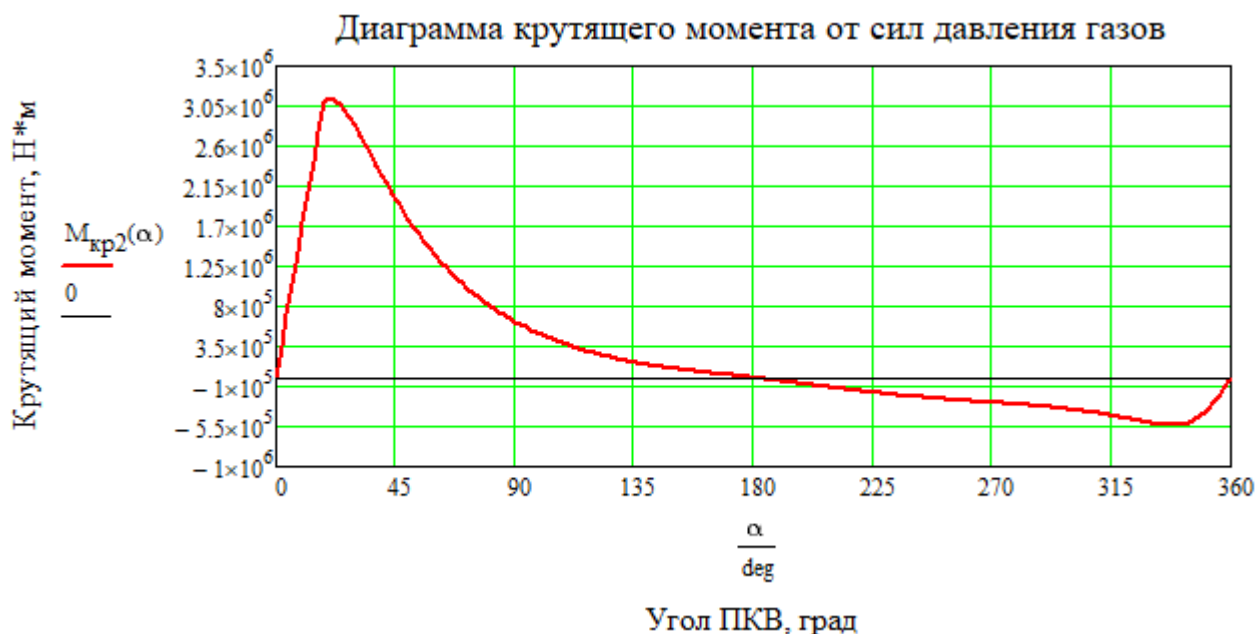
Рисунок 3. Диаграмма крутящего момента от сил давления газов
