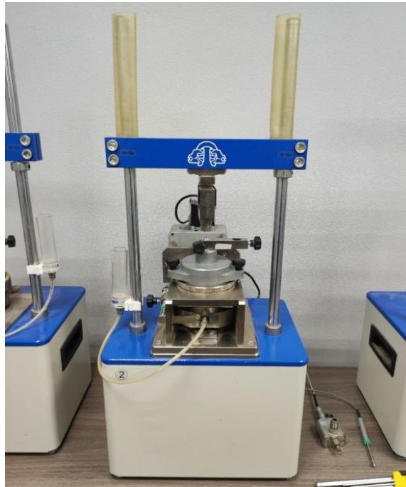
Рисунок. 3. Прибор испытания грунтов методом одноплоскостного среза НПП «Геотек»
