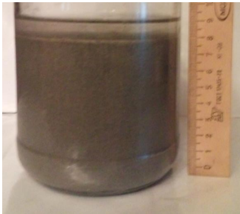
Рисунок 5 - Битумная суспензия, армированная фиброй, через сутки после перемешивания
