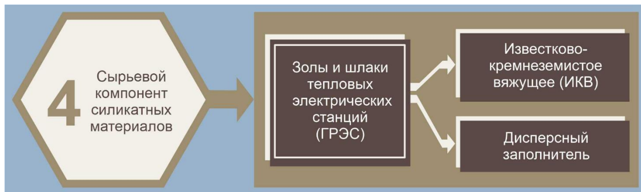
Рисунок 5 – Блок-схема использования золошлаковых отходов в качестве сырьевого компонента силикатных материалов
