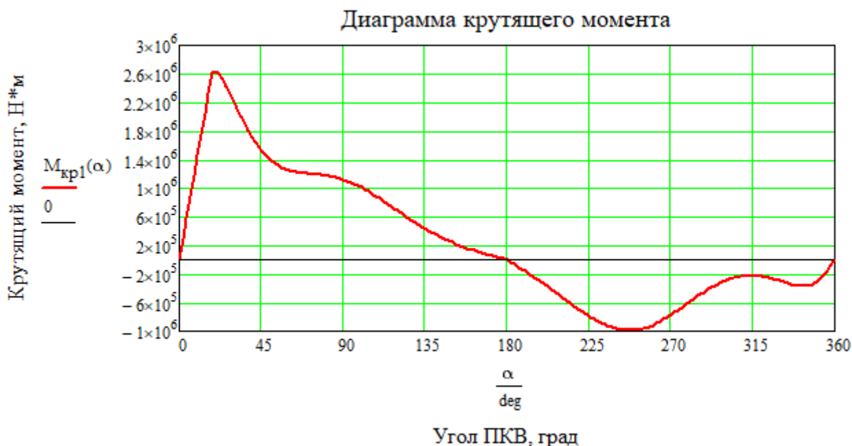
Рисунок 1. Диаграмма крутящего момента двухтактного дизеля
