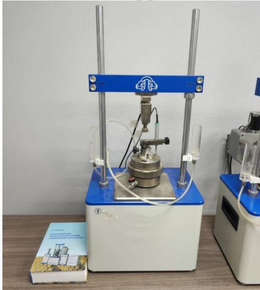
Рисунок. 1. Компрессионный прибор компании НПП «Геотек»
