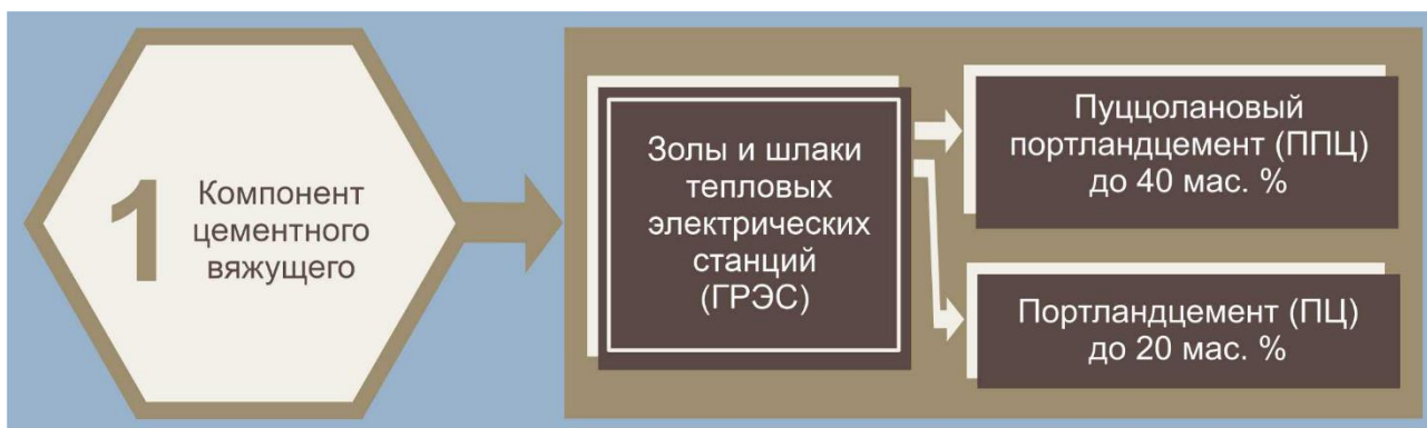
Рисунок 2 – Блок-схема использования золошлаковых отходов в качестве компонента цементного вяжущего
