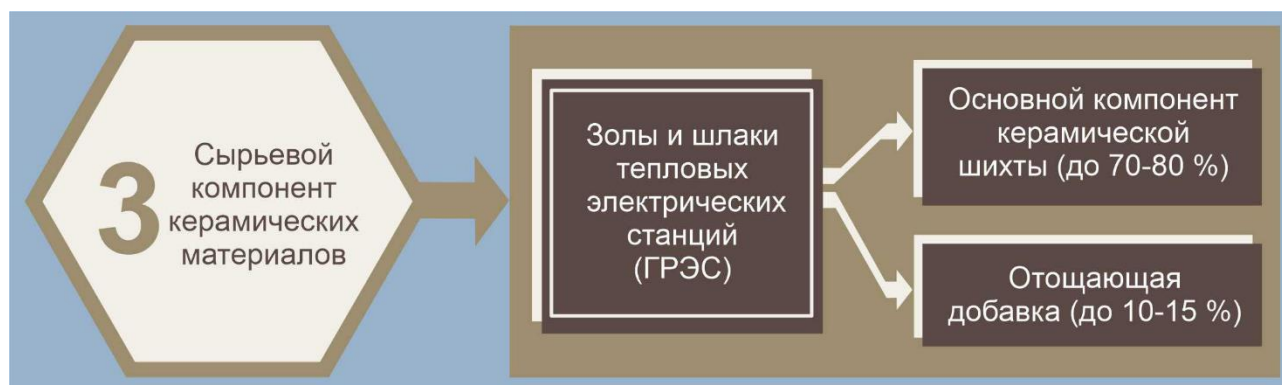
Рисунок 4 – Блок-схема использования золошлаковых отходов в качестве сырьевого компонента керамических материалов
