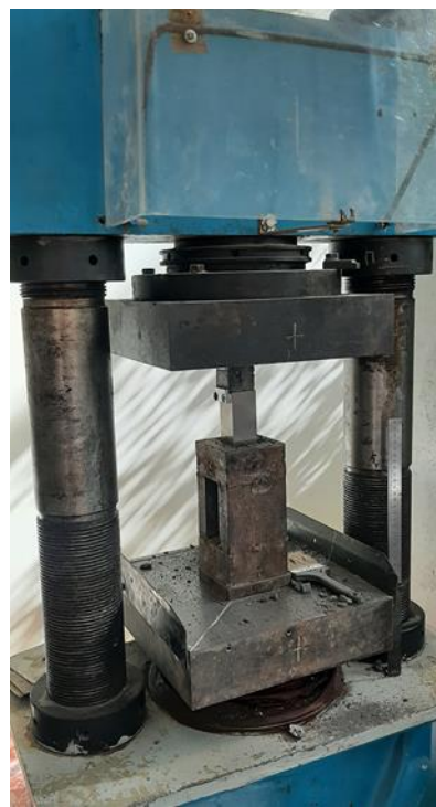
Рисунок 4 – Испытания образца на предел прочности при сжатии
