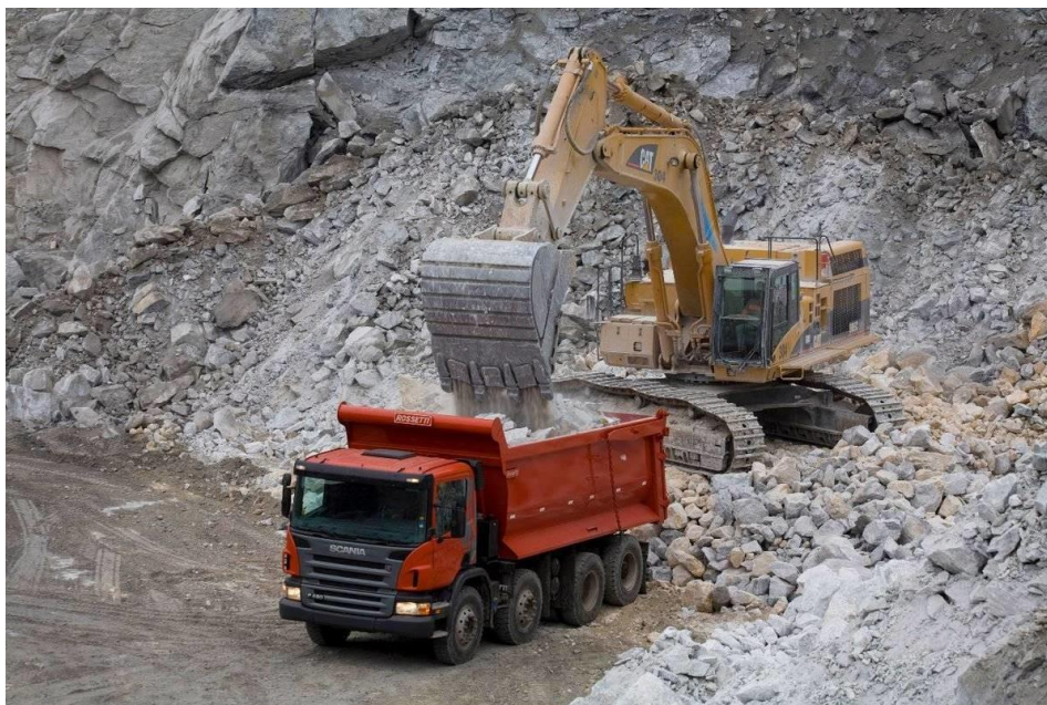
Рисунок 1. Погрузка скального грунта экскаватором на самосвалы
