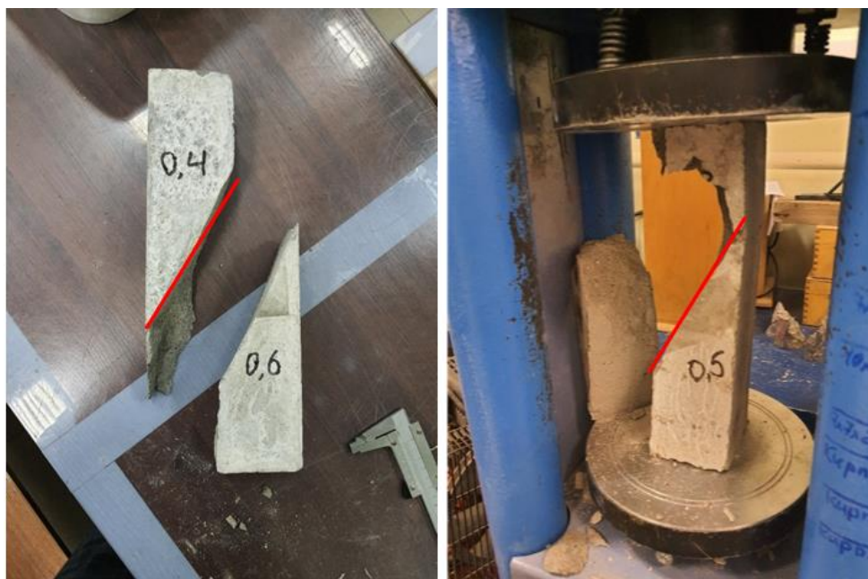
Рисунок 4 – Общий вид разрушения образцов
