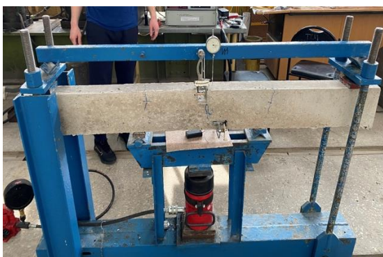
Рисунок 2. Схема испытания образцов-балок. а) расположение сил и приборов; б) крепление тензометра T1 ; в) крепление тензометров T2 , T3 ; г) крепление индикатора измерения прогибов; 1 – балка; 2 – траверса для измерения прогибов; 3, 4 – струбины для крепления тензометров T2 , T3 . Фото экспериментальной установки
