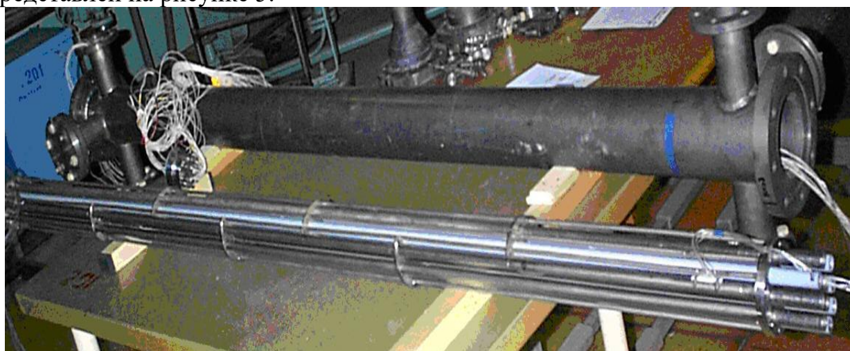
Рисунок 5. Натурная модель теплообменника
