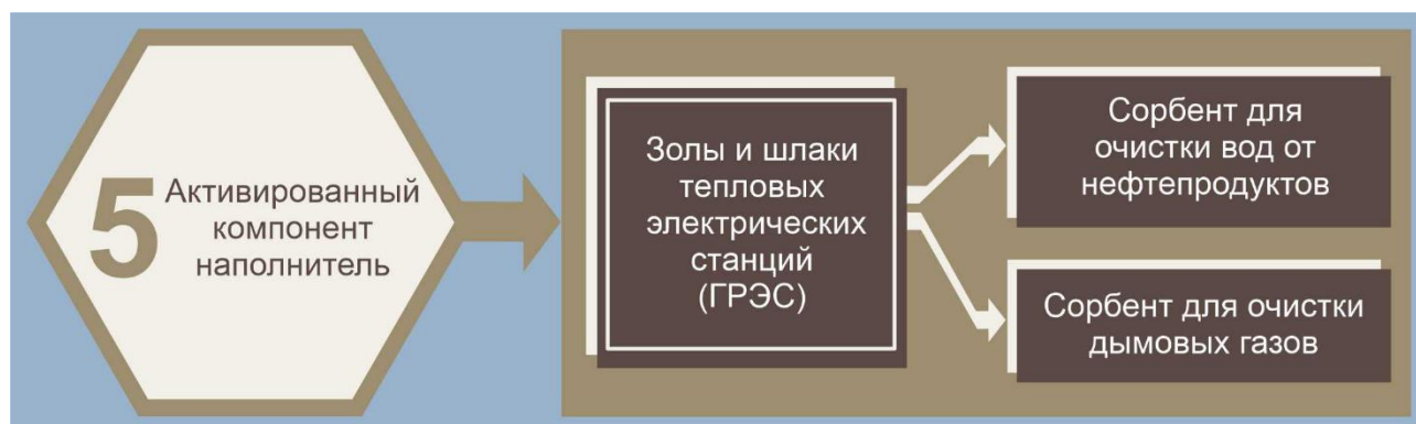
Рисунок 6 – Блок-схема использования золошлаковых отходов в качестве активированного компонента сорбентов для очистки жидкостей и газов
