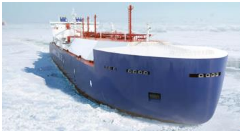
Рисунок 3 – Танкер-газовоз СПГ с ВРК 15МВт
