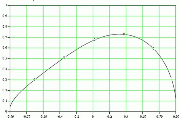
Рисунок 2 – Зависимость дальности полёта от угла вылета
