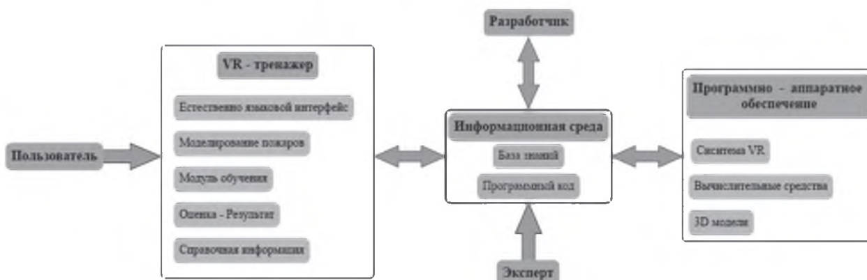
Рис. 3. Архитектура VR-тренажера для обеспечения процесса обучения тактике борьбы с пожарами на морском транспорте
