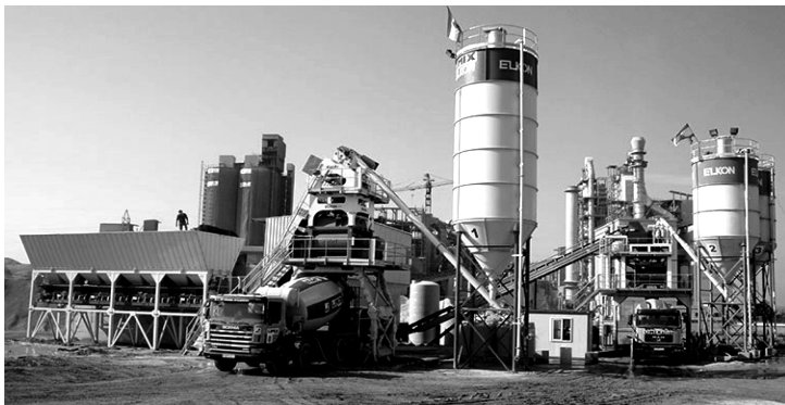
Рис. 2. Быстромонтируемый бетонный завод QUICK MASTER 120
