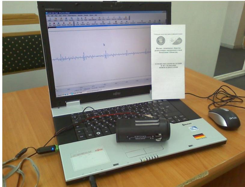
Рис.3. – Подключенный электронный фонендоскоп ФСЭ-1М
