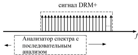
Рис. 2. Последовательный анализатор спектра для обнаружения сигнала DRM+.
