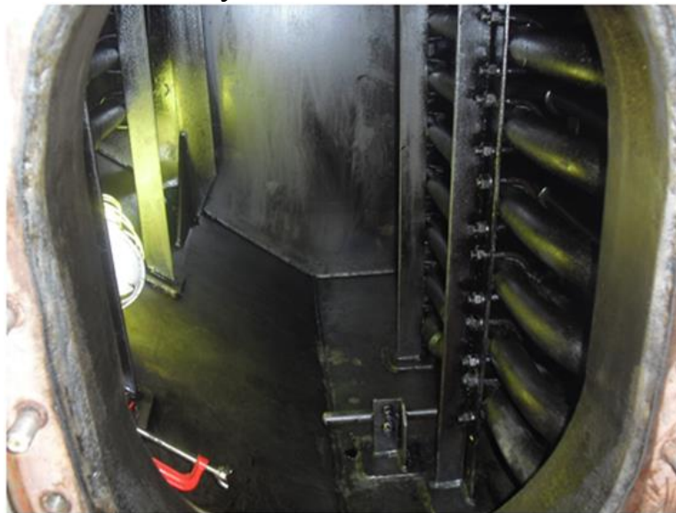
Рис. 1. Змеевики общего подогрева топлива в бортовой цистерне
