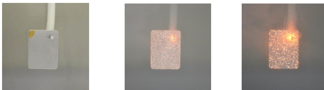
Рис. 2 Процесс плазменного электролитического оксидирования.
