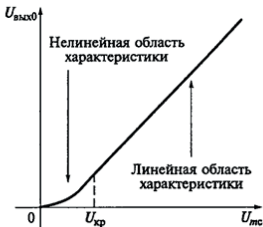
Рис. 3. Детекторная характеристика амплитудного детектора
