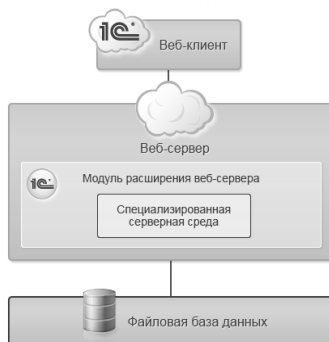
Рис. 4. Схема работы веб-клиента
