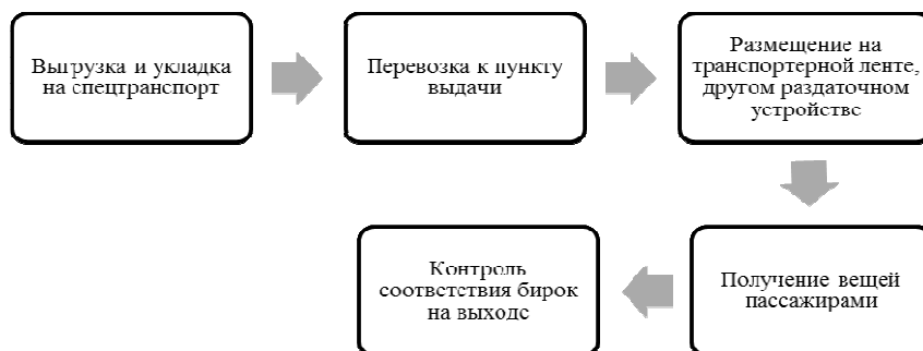
Рис. 2. Технологический процесс обработки багажа прибывающих рейсов
