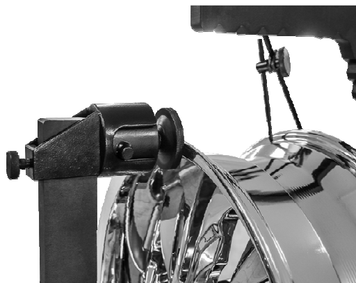
Рис. 2. Обкатка автомобильного диска
