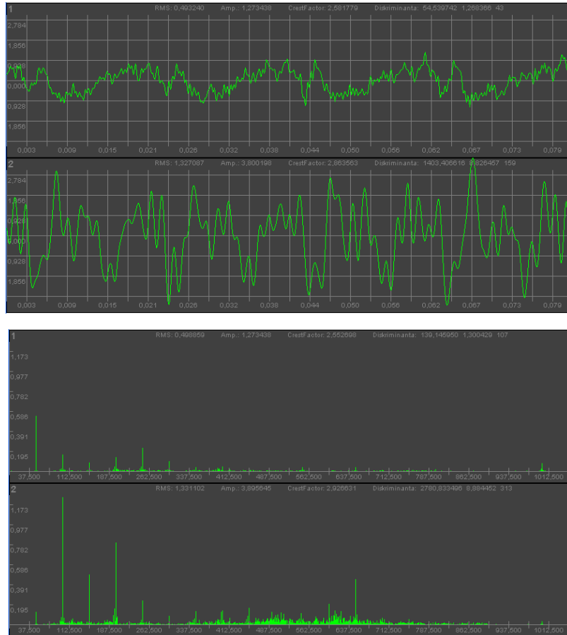
Рис. 1. Временные реализации и амплитудные спектры вибрационных сигналов, возбуждаемых подшипниковой опорой турбоагрегата
