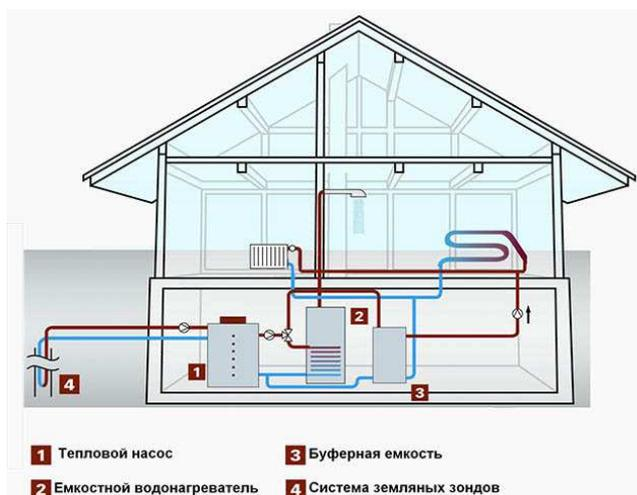
Рис. 1. План размещения системы с тепловым насосом
