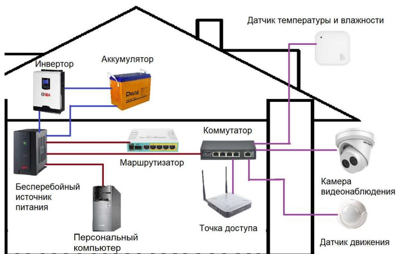
Рис. 3. Схема подключения электропитания
