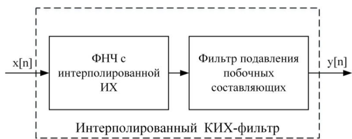
Рис. 2. Структура интерполированного КИХ-фильтра.
