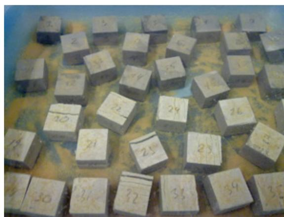
Рис. 2. Воздействие первого цикла замораживания-оттаивания на образцы доломитизированного известняка (Срассола=100 г/л,  $t=-10^{\circ}\text{C}$ )
