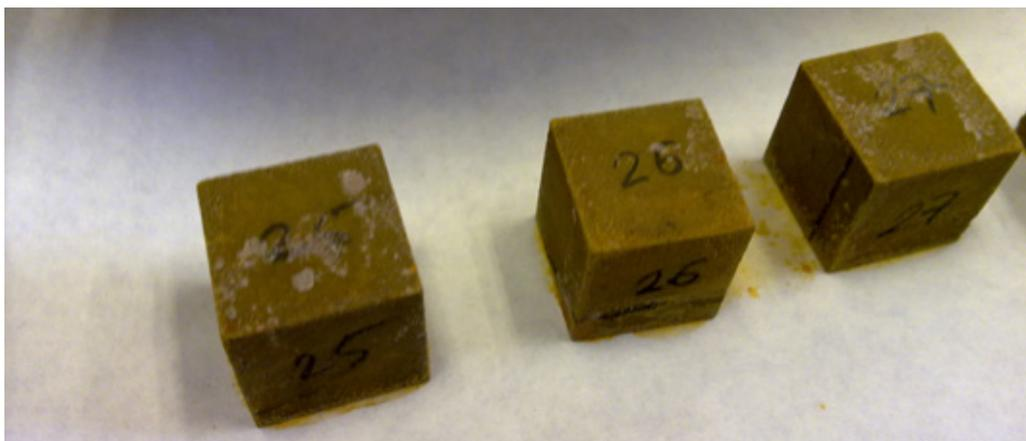
Рис. 3. Воздействие 5 циклов замораживания-оттаивания на образцы доломита (Срассола=200 г/л, t=-20 °C)
